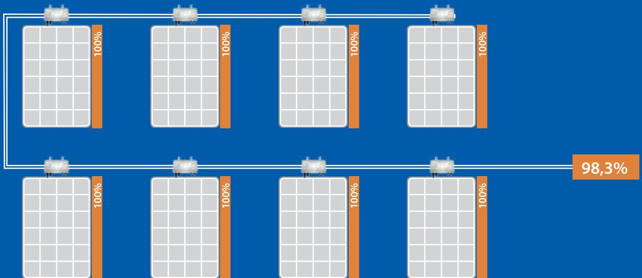
Der Gleichstrom wird am Modul umgewandelt und als Wechselstrom übertragen. Durch die hohe AC-Spannung geht kaum Leistung verloren.
