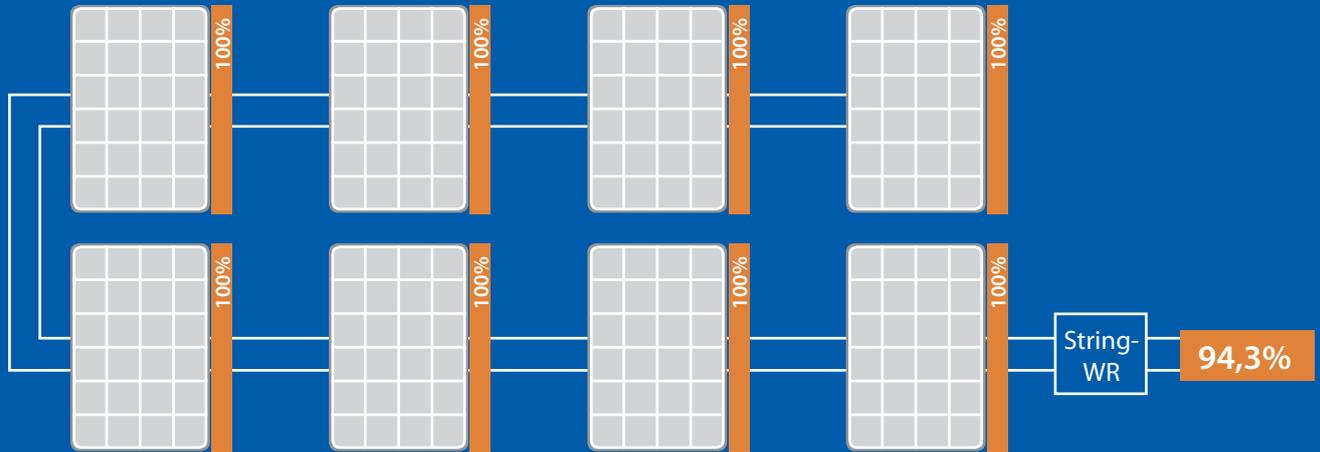
Der hohe PV-Gleichstrom muss erst lange Wege durch die Anlage durchlaufen bis er im String-Wechselrichter in Wechselstrom umgewandelt wird. Aufgrund der langen Wege und des hohen Stromes geht viel Leistung verloren.
